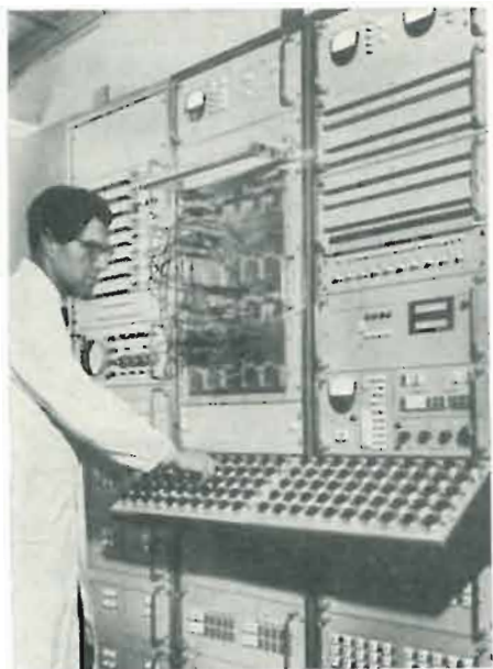
Calcolatore analogico completamente transistorizzato costruito dalla TELEFUNKEN AG, mod. RA 800.
