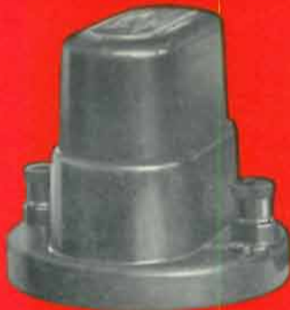
Pila campione Weston Modello 4
